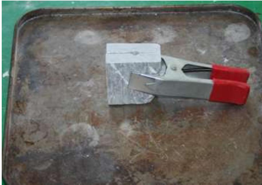
Figure 10 - Mold clamped for pour
